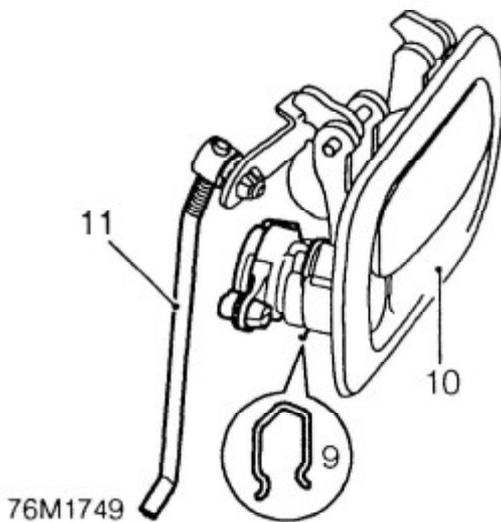
9. Clip zur Befestigung des Schlosses am Griff lösen und Schloß entfernen.
