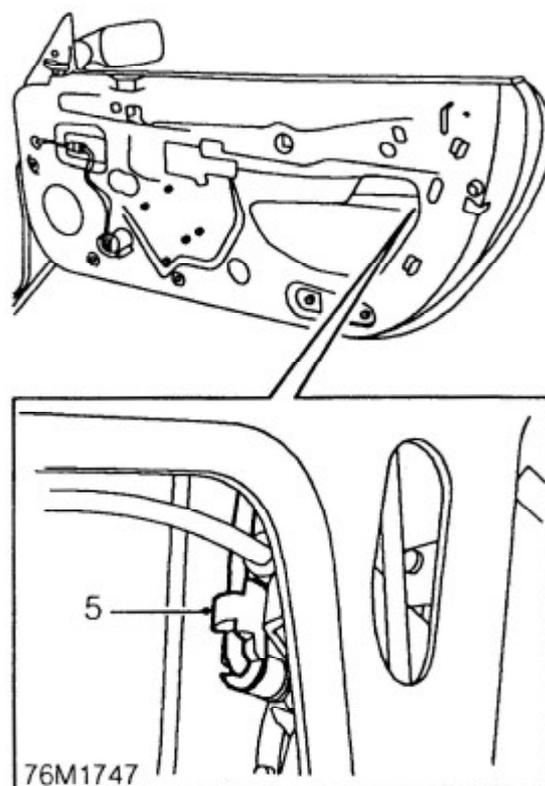
5. Clip zur Befestigung der Türgriffverbindungsstange an der Schloßfallengruppe lösen und beiseite führen.
